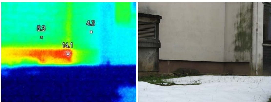
Slika 13: Toplotne izgube skozi ovoj fasade v OŠ Ivana Cankarja na Lošci
