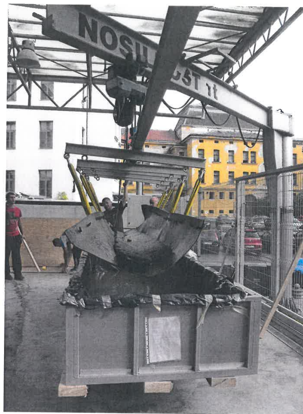
Slika 7: Ker so posamezni kosi izredno težki, smo izdelali posebno konstrukcijo, s katero jih lahko dvigujemo.
