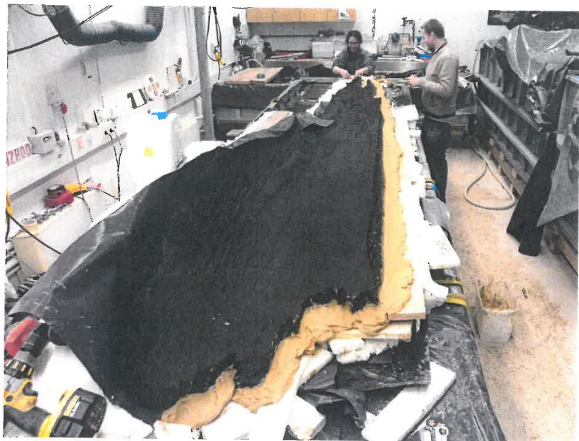
Slika 8: Pred izdelavo epoksi kapsul moramo pripraviti t.i. ograjice, ki omejuje obliko kapsule. Njihovo obliko dosežemo s podlaganjem s stiroporom in končnim oblikovanjem iz gline.
