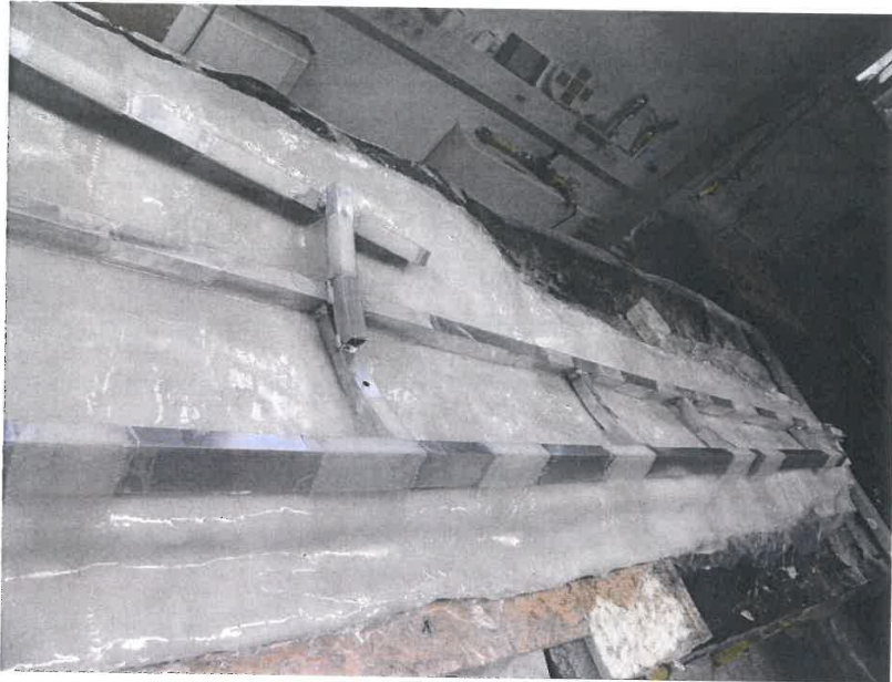
Slika 12: Kapsule so ojačane z aluminijastim ogrodjem.
