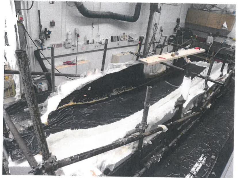
Slika 11: Tri faze izdelave kapsule (z leve): očiščena površina lesa; pripravljena ograjica s prevleko iz folije, na katero bomo nanesli smolo; že izdelana tretjina kalupa.
