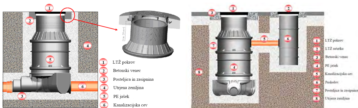
Standardni PE revizijski jašek.
