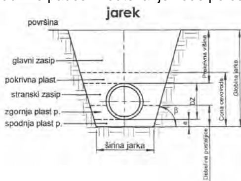
Prikaz izkopa jarka za meteorno kanalizacijo (SIST EN 1610)
